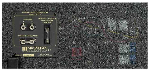
Das Anschlussfeld mit der Weiche hinter der Bespannung. Fürs Feintuning kann man die Sicherung durch eine bessere ersetzen und das Metallstück für die Hochtonanpassung mit einer Kabelbrücke tauschen
