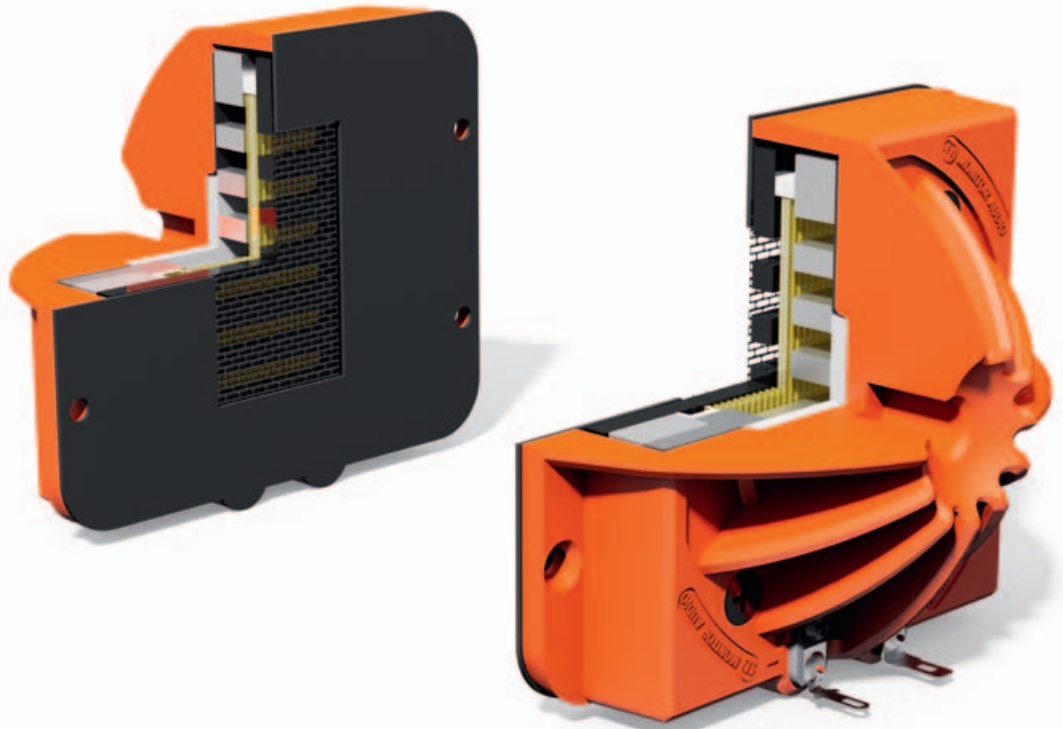
Micro Pleated Diaphragm (Mikrofaltenmembran) nennt Monitor Audio den neu entwickelten Air-Motion-Transformer, der den Bändchen-Hochtöner aus der ursprünglichen Serie ablöst. Er hat eine deutlich größere Oberfläche als gängige Hochtonkalotten und ist daher wesentlich effizienter, auf der anderen Seite aber auch deutlich klirrärer.
